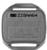
Transpondedor especial para cronometraje de karts, optimizado para evitar interferencias eléctricas a alturas de detección < 0,5 m. Garantiza la máxima fiabilidad y precisión durante decenas de miles de vueltas en carreras de karts.
